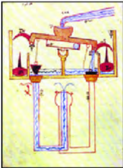
(١٣٨) نافورة من صنع الجزري تقوم على فكرة . تمرير الكفتين بفعل الماء باستخدام السطل القلاب .
